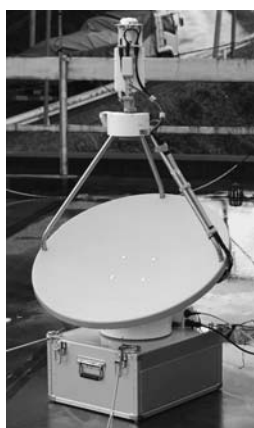
▲VSAT衛星通信システム
